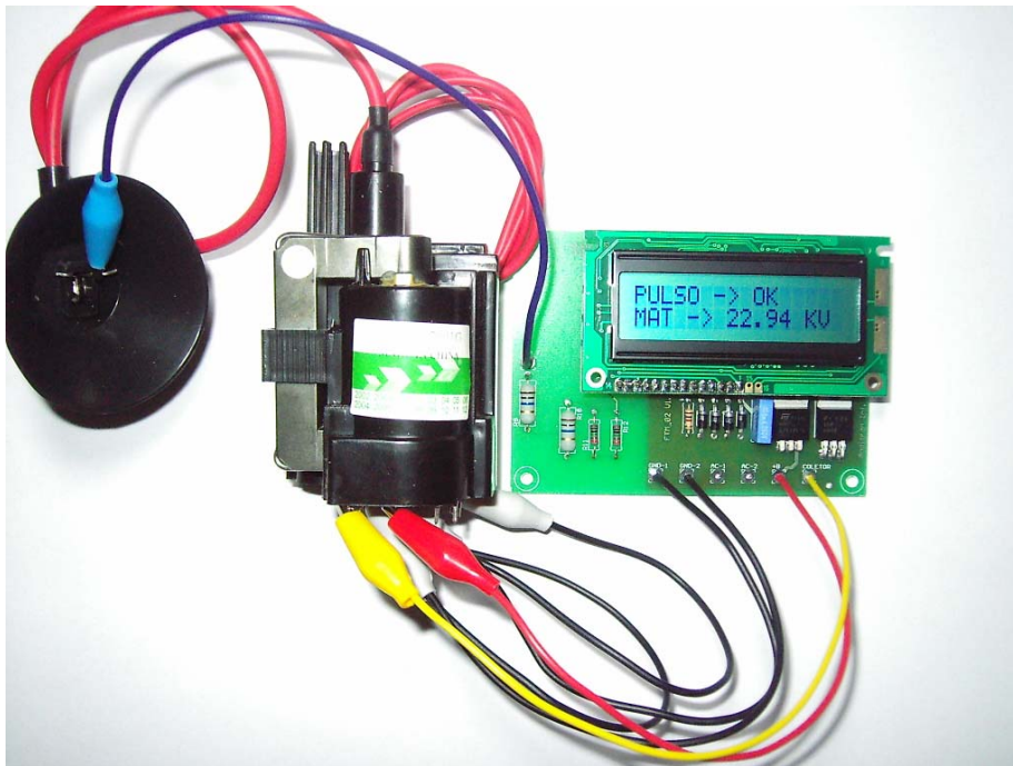
Teste em funcionamento analisando um flyback 6174Z-2001G
